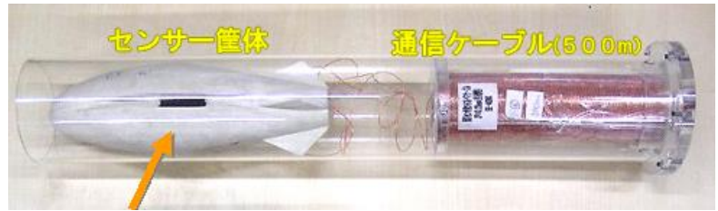
図3 試作投下式センサー（水深500m対応） (5)
